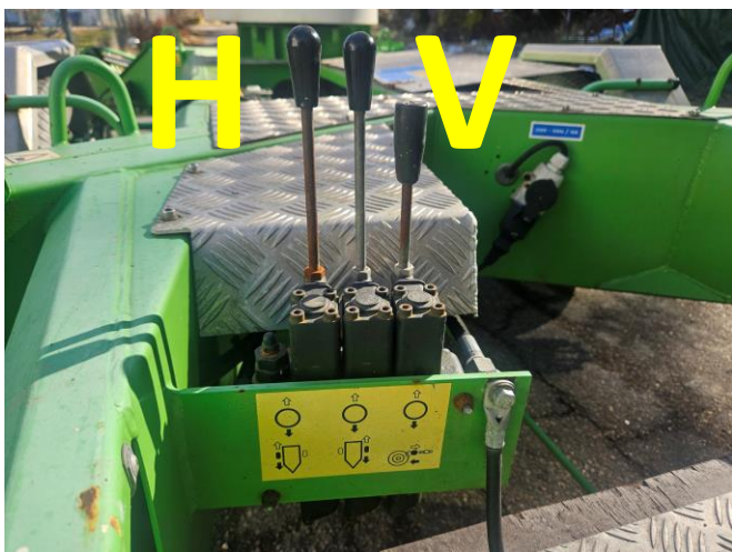
12. De två långa spakarna är drivning till varsin sida Varje spak har Mittläge, Fram och Back OBS! Reglera med försiktiga rörelser
