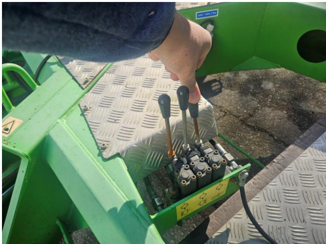
8. Lägg an drivrullarna (Korta spaken) 2 lägen Max ut eller Max in
